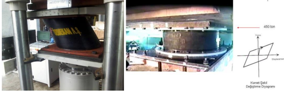
Şekil 3. Kurşun çekirdekli kauçuk izolatörler
