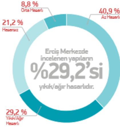
Şekil 4. Erciş Merkez Genel Hasar Durumu
