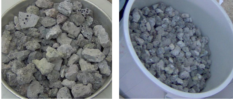
Şekil 2. FeCr cürufları; Solda boyutu 25 mm'den büyük olan, sağda 20-25 mm arası cüruf
