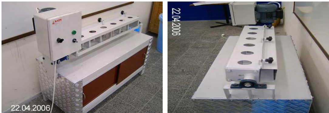
Şekil 4. SPLP aşamalarında numune çıkarımında kullanılan döner çalkalama aygıtı (Liç Reaktörü), (Yıldız, 2008)
