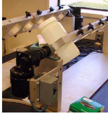
Şekil 3. TCLP ve SPLP aşamalarında numune ekstraksiyonunda kullanılan döner çalkalama aygıtı (Pendowski, 2003)
