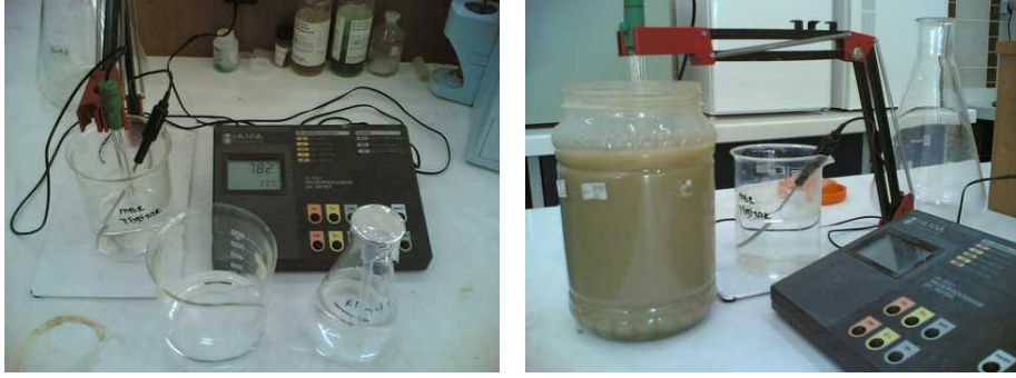
Şekil 6. Liç ekstraksiyon numunesi ve pH metre ile son pH ölçümü
