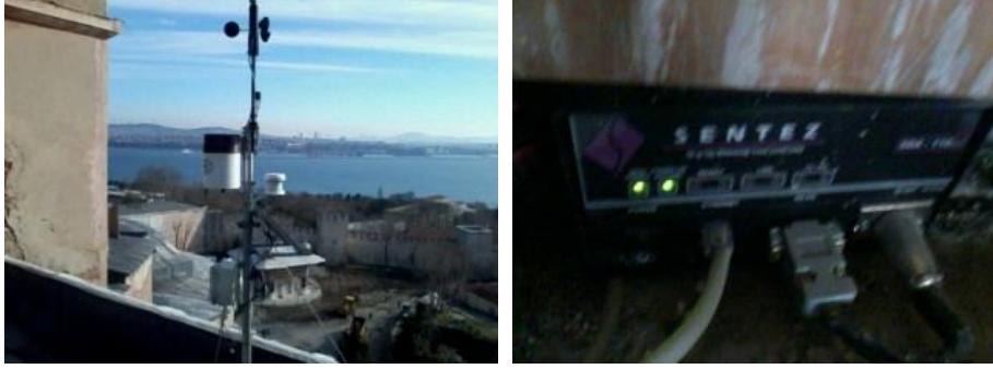
Şekil 13. Ayasofya Müzesinde kurulan izleme sistemleri: Meteorolojik izleme sensörleri (solda), Akselerometre (sağda) (Foto:A.Kuzucuoğlu arşivi).
