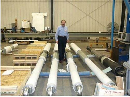
Şekil 3. Çin’de Xihoumen Köprüsünde Kullanılan Sönümleyici Uygulaması (Constantinou, 2013). Şekil 4. Viskoz Sönümleyici (Constantinou vd.,1998)
