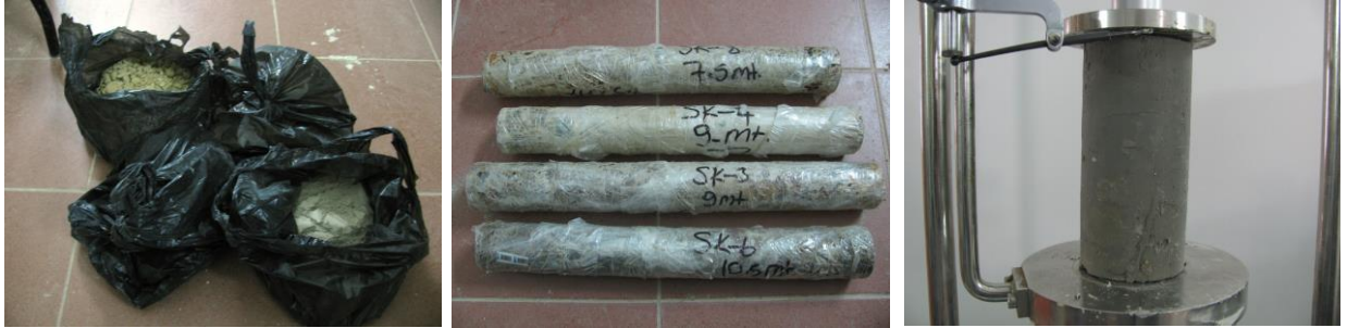
Şekil 5. Araziden sadece poşetlenerek laboratuara getirilmiş örselenmiş örnekler (solda) ve UD tüpü ile alınarak sarılıp laboratuara getirilmiş örselenmemiş örnekler (ortada) ve bu örnekler kullanılarak yapılan drenajsız kayma direnci testi (sağda).
